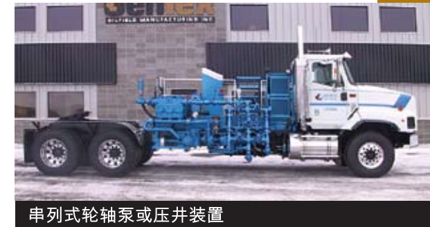
装在两吨底盘上的压力装置
